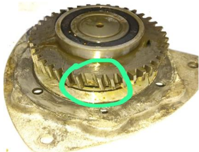
Şəkil 3. Həddindən artıq yüklənmə zamanı dişli çarxın dişinin qırılması
