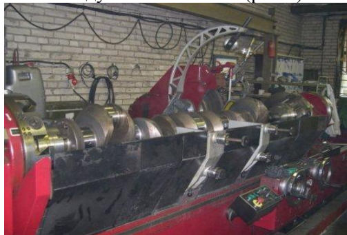
Рис.2.Высококачественная обработка шеек коленчатых валов на станке AMC-SCHOU K2000U с восстановлением правильной геометрии.
