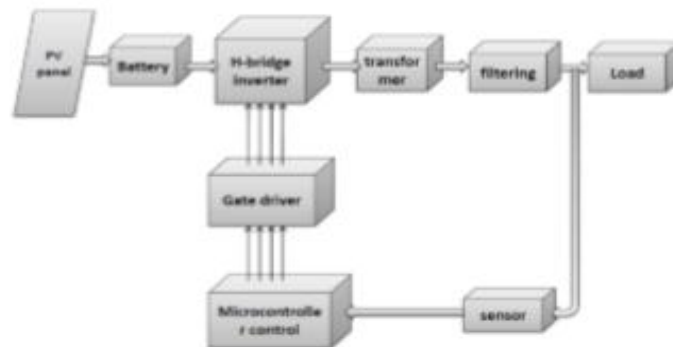
Şəkil 1. Təklif olunan sistemin 1 struktur sxemi.
