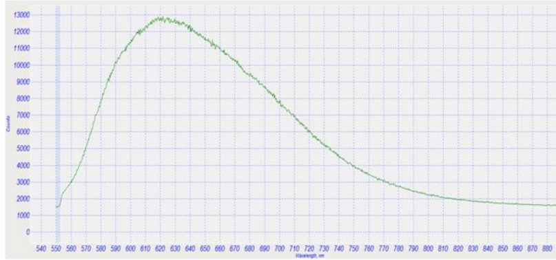
Şəkil 3. ZnS kristallarının lüminessensiyə spektri ( \lambda = 532 \text{ nm} )
